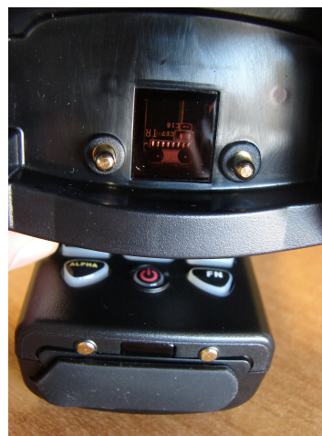
Rys.6 Okienka portów podczerwieni bazy i kolektora
